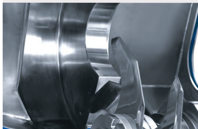
Wąska pokrywa nożowa dla poprawy jakości farszu mięsnego Narrow knife cover for improving the quality of meat stuffing
