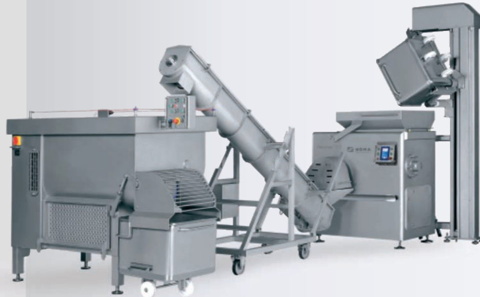
Example of an automatic line of grinder - mixer Ejemplo de la linea automatica de picadora
